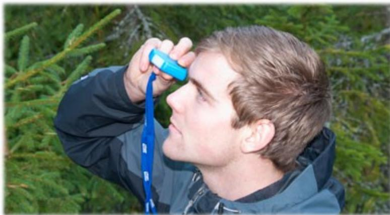
Pokrenite instrument pritiskom na tipku. Izmjerite željeni kut ciljanjem s vodoravnim crtama na zaslonu instrumenta i pritisnite gumb za zaključavanje rezultata. BILJEŠKA! Koristite oba oka kada ciljate! Nastavite mjeriti bilo koji kut jednostavnim ciljanjem, pritiskom i očitavanjem rezultata na zaslonu instrumenta. Klinometar Haglöf C I tvornički je podešen da prikazuje rezultate u stupnjevima ili postocima
